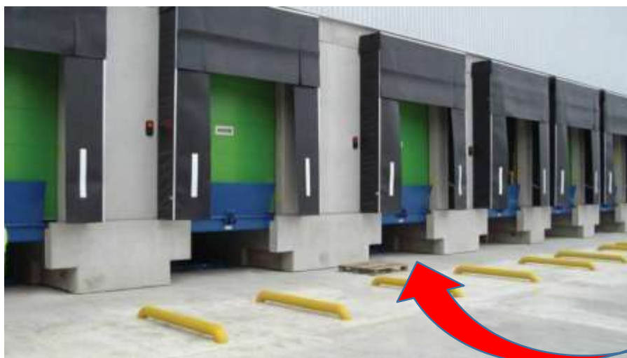
Esempio di fronte CON vano sponda inferiore
